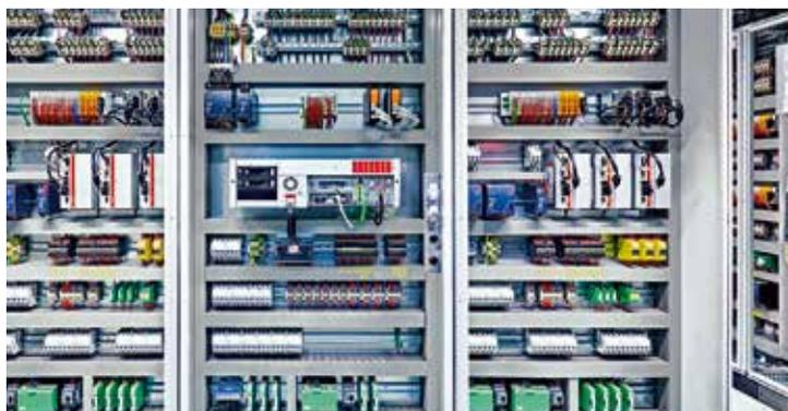
**All'interno del quadro di controllo, i controllori per le 12 stazioni di prova sono disposti in due gruppi indipendenti con sei stazioni di prova ciascuno**
