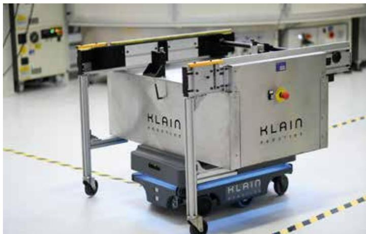
**I due MiR200 movimentano i pallet kit di 180 kg che raccolgono i componenti necessari per costruire uno specifico martello, in un particolare versione con ID univoco**
