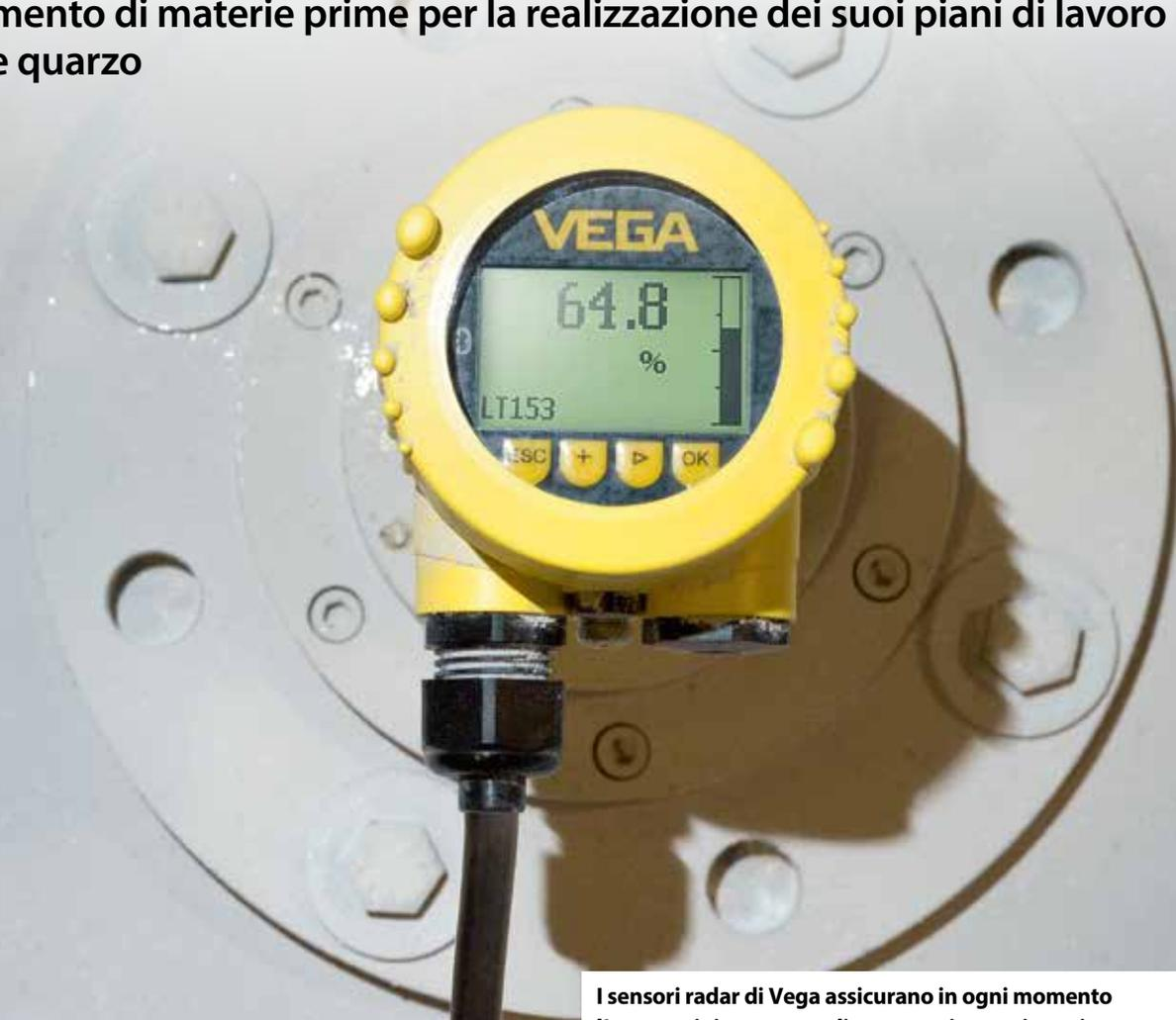
**I sensori radar di Vega assicurano in ogni momento l'approvvigionamento di quarzo, pigmenti e resine**
