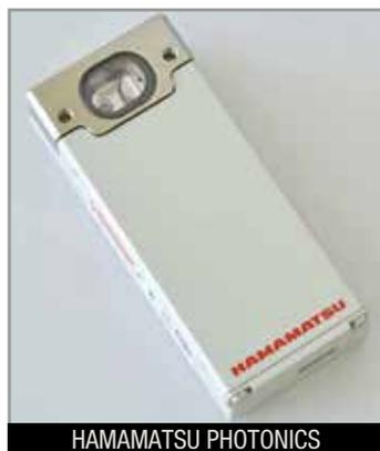
I sensori Mems-FPI sono composti da un fotodiodo InGaAs e un interferometro Mems-Fabry-Perot. La distanza tra gli specchi dell'interferometro può essere regolata variandone la tensione applicata, in questo modo il dispositivo si comporta come un filtro passabanda regolabile ad ampio spettro. Il modulo, integrando anche
