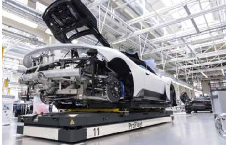
**In questa moderna smart factory, la linea di montaggio tradizionale scompare per lasciare posto a isole di lavoro autonome e i moderni AGV**
