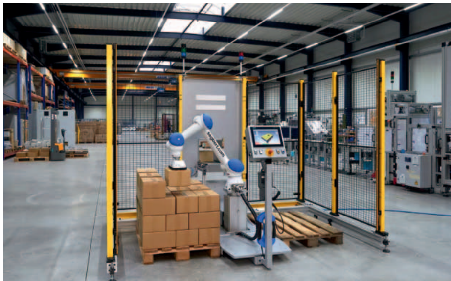
La serie Motoman HC (Human Collaborative) comprende robot ibridi ideati per la collaborazione con l’uomo che possono funzionare ad alta velocità o a una velocità sicura e ridotta ogni volta che una persona entra nell’area di lavoro
