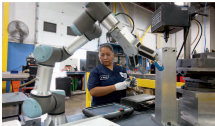
UR3 è il cobot più compatto della gamma UR. Si tratta di un robot collaborativo di appena 11 kg di peso
