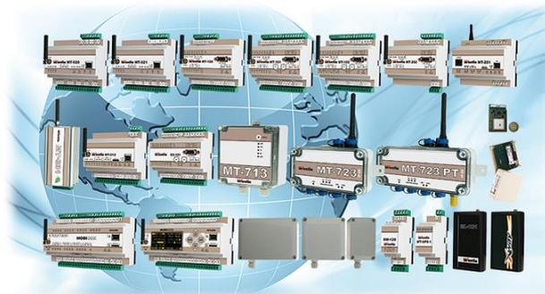
Tutti i moduli, dal semplice sensore al sistema di acquisizione dati con controllore logico on board, sfruttano la tecnologia GSM/GPRS e sono semplici da configurare ed implementare da integratori o dagli stessi utenti grazie a strumenti software intuitivi.
